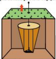
Мягкий связный грунт (На основе расчета Свемттона)
